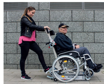
Incline o passageiro juntamente com a cadeira de rodas até se ouvir o som do encaixe. Conduza de seguida o equipamento até as escadas.
